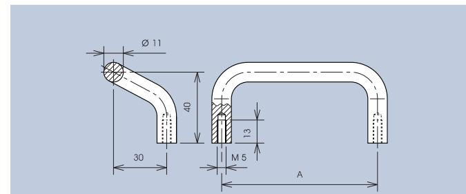
Einschließlich Zylinderschrauben-M5 x 12 und Scheiben.
