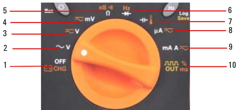
Figure 1-6 Commutateur rotatif
