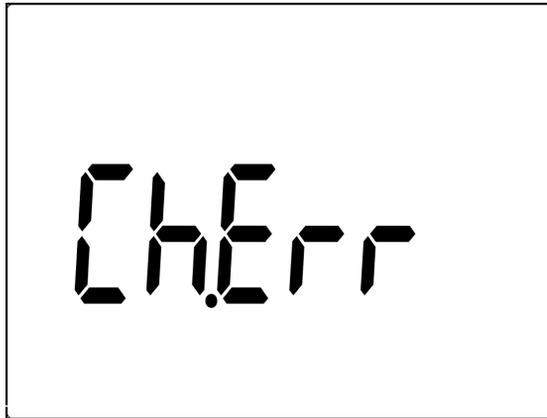
**Figure 2-17** Alarme de la borne de charge
