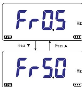
Figure 4-10 Modification de la fréquence minimale mesurable
