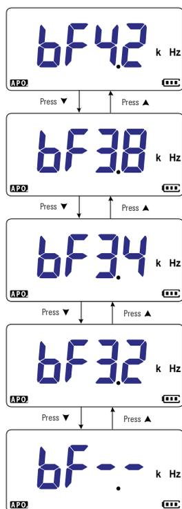
Figure 4-4 Modification de la fréquence du signal sonore
