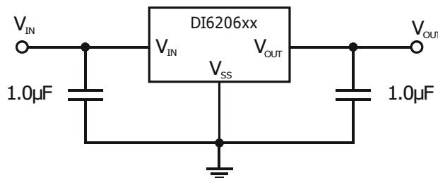
**Fig. 1** Typische Anwendungsschaltung für DI6206xxS1
