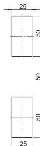
Kształt i wymiar otworów do osadzenia zamka
