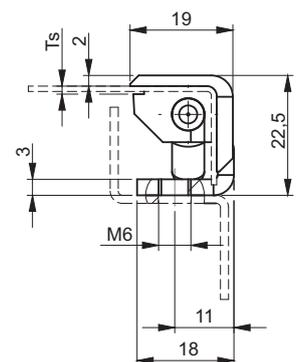
Ts - grubość blachy montażowej [mm]
