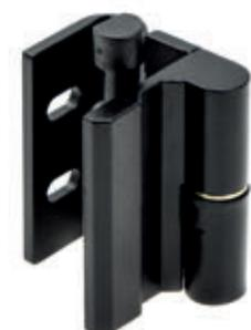
Петля с углом открытия 180° с блокировкой которая предотвращает снятие двери шкафы при закрытых дверях и углу открытия меньше чем ~60°
