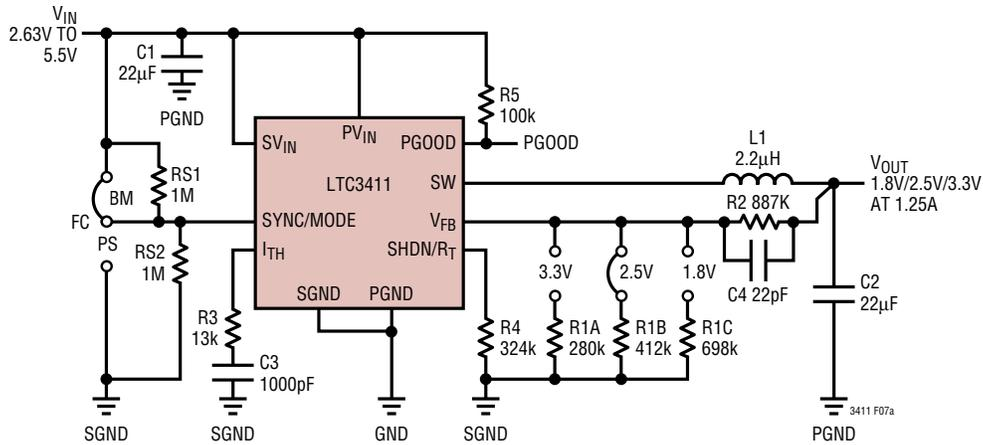
NOTE: IN DROPOUT, THE OUTPUT TRACKS THE INPUT VOLTAGE
