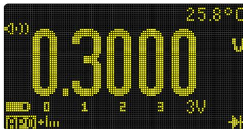
**Figura 2-18** Visualización de diodo
