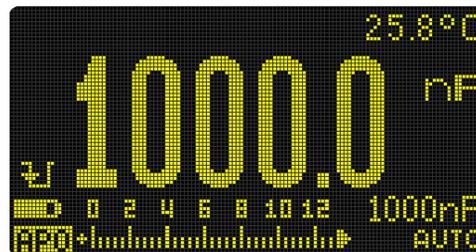
**Figura 2-24** Visualización de capacitancia
