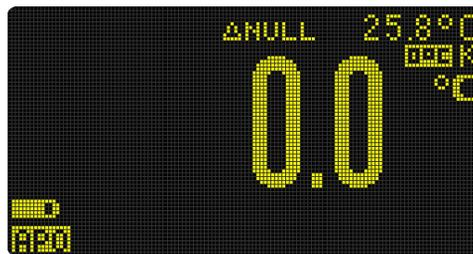
Figura 2-28 Medición de temperatura sin compensación ambiental
