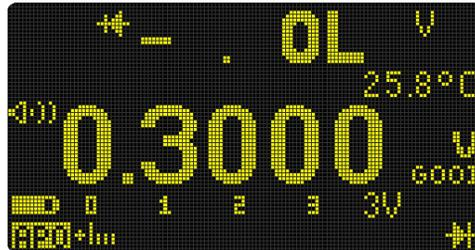
Figura 2-22 Visualización de autocomprobación de diodo - Estado: Good (Bien)
