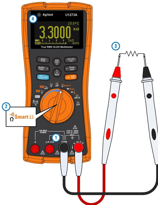
Figura 2-12 Medición de resistencia
