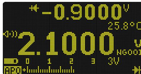
Figura 2-23 Visualización de autocomprobación de diodo - Estado: nGood (No muy bien)
