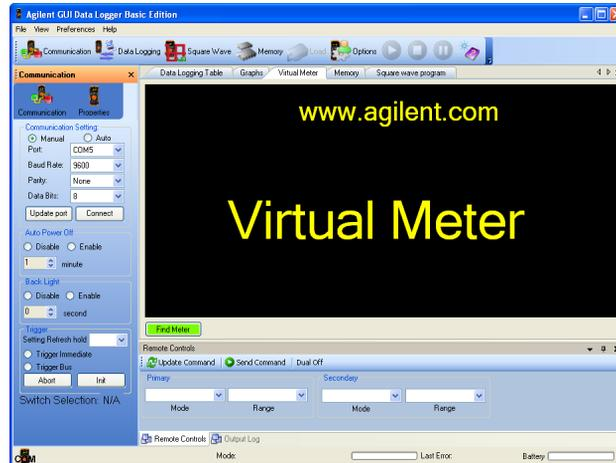
**Figura 1-7** Software para el registro de datos de la interfaz gráfica de usuario de Agilent.
