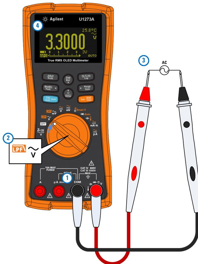
Figura 2-2 Medición de tensión de CA
