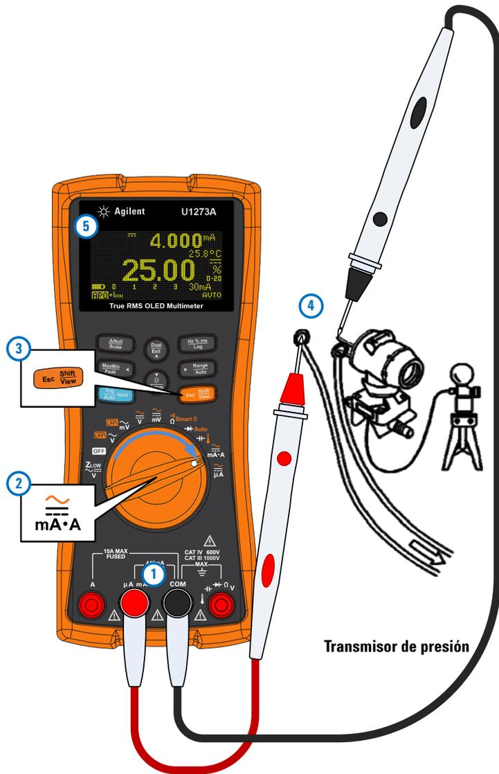
Figura 2-34 Medición de corriente CC utilizando la escala de % 0-20 mA
