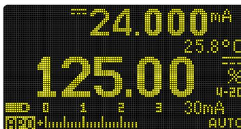
**Figura 2-33** Visualización de la escala de % 4-20 mA
