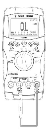
Abbildung 5-7 Überprüfen der Sicherungen
