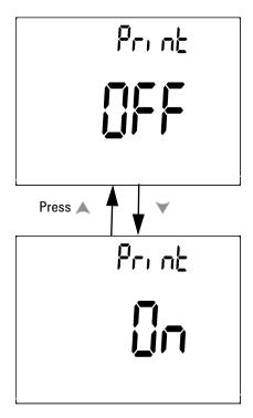
Abbildung 4-15 Einrichtung des Druckmodus für die Fernsteuerung
