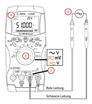
Abbildung 2-1 Messen der AC-Spannung
