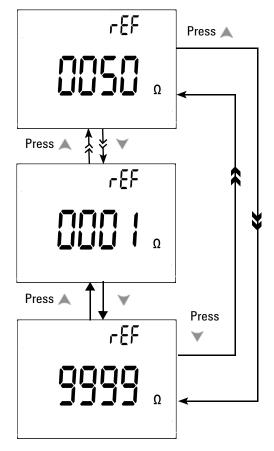
Abbildung 4-4 Einrichtung der Referenzimpedanz für dBm-Messung
