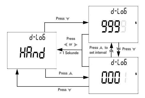
Abbildung 4-2 Einrichtung der Datenprotokollierung
