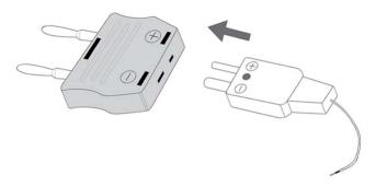
Abbildung 2-13 Anschließen der Wärmesonde am Übertragungsadapter ohne Ausgleich
