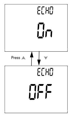
Abbildung 4-14 Einrichtung des Echomodus für die Fernsteuerung
