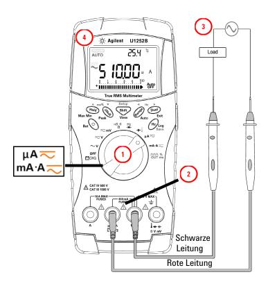
**Abbildung 2-3** Messen der  $\mu$ A- und mA-Stromstärke
