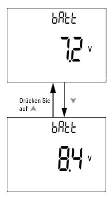
Abbildung 4-17 Batteriespannungswahl
