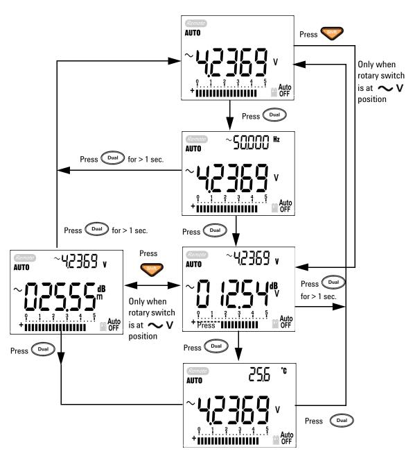
Abbildung 3-5 dBm/dBV-Anzeigemodus
