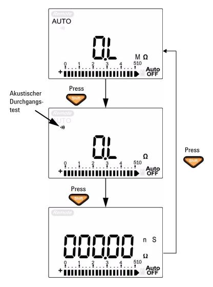
Abbildung 2-8 Akustischer Durchgangstest, Leitfähigkeit und Widerstandstest.
