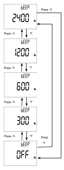
Abbildung 4-9 Einrichtung der Signaltonfrequenz
