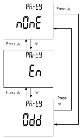
Abbildung 4-12 Einrichtung der Paritätsprüfung
