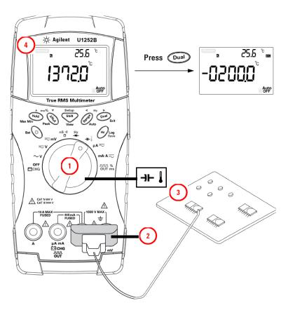
Abbildung 2-15 Oberflächentemperaturmessung
