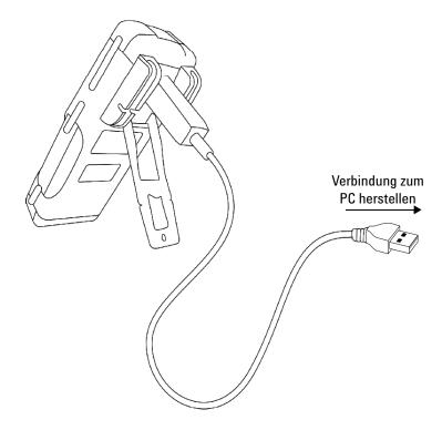
**Abbildung 3-14** Kabelverbindung für die Remotekommunikation
