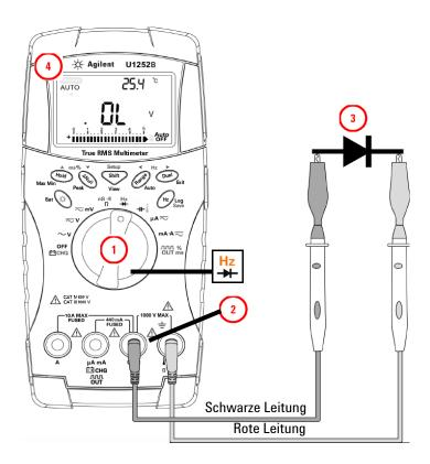
Abbildung 2-11 Messen der Sperrvorspannung einer Diode
