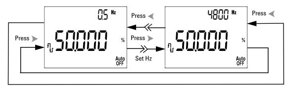
Abbildung 3-11 Frequenzanpassung für Rechteckwellenausgabe
