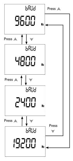
Abbildung 4-11 Einrichtung der Baudrate für die Fernsteuerung
