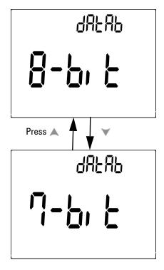
Abbildung 4-13 Einrichtung des Datenbits für die Fernsteuerung
