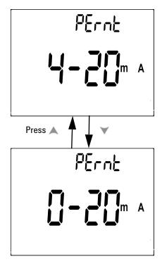
Abbildung 4-8 Einrichtung der %-Skalenausgabe
