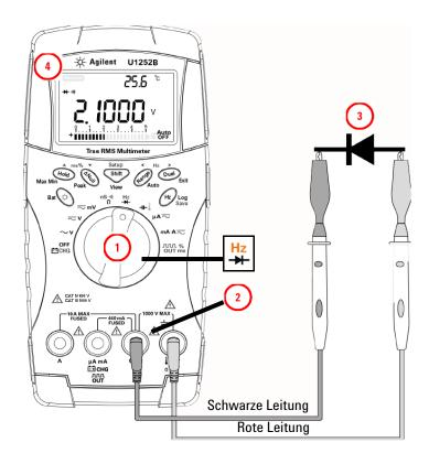
Abbildung 2-10 Messen der Vorwärtsspannung einer Diode
