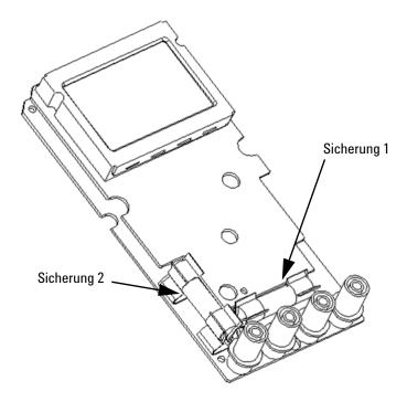
Abbildung 5-8 Sicherungsaustausch
