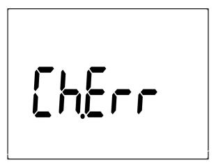
Abbildung 6-3 Ladeanschluss-Alarm
