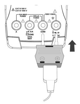
Abbildung 2-14 Anschließen der Sonde mit Adapter am Multimeter
