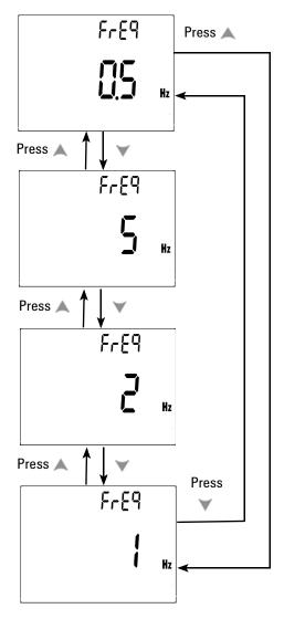
Abbildung 4-5 Einrichtung der Mindestfrequenz
