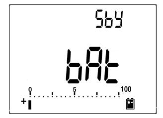
Abbildung 5-2 Akkukapazitätsanzeige beim Auffrischen
