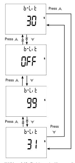
**Abbildung 4-10** Einrichtung des Hintergrundbeleuchtungs-Timers
