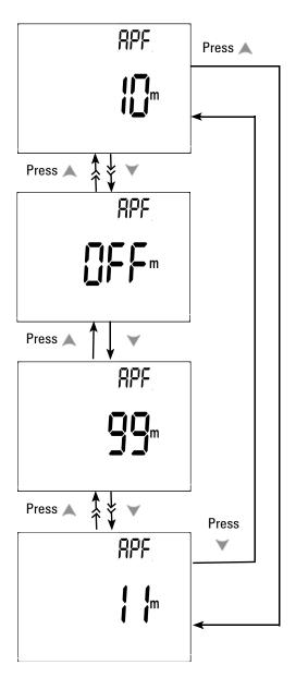
Abbildung 4-7 Einrichtung des automatischen Energiesparmodus
