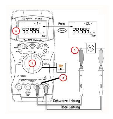
Abbildung 2-6 Messungsfrequenz
