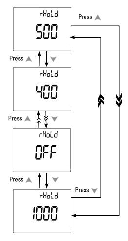
Abbildung 4-1 Einrichtung von Daten halten/Halten aktualisieren
