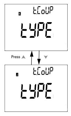
**Abbildung 4-3** Einrichtung des Thermoelementtyps
