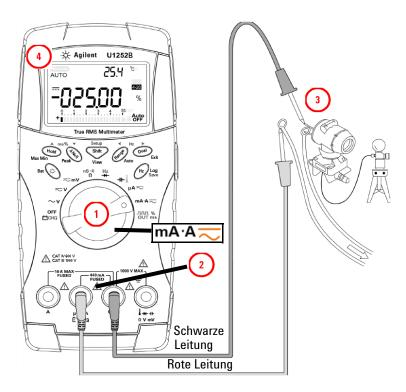
Abbildung 2-4 Messen der Skalierung von 4-20 mA
