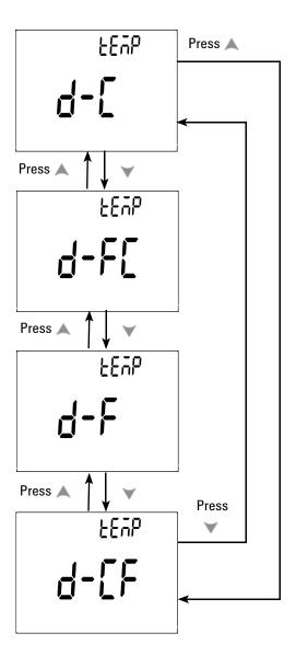
Abbildung 4-6 Einrichten der Temperatureinheit
