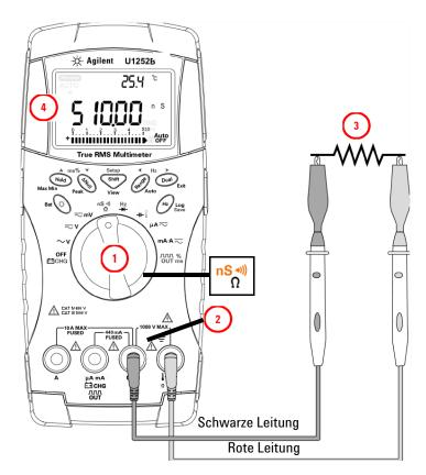
Abbildung 2-9 Leitfähigkeitsmessung
